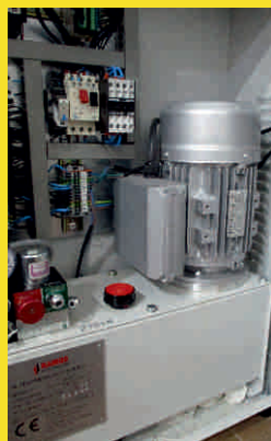
Armario de chapa para grupo hidráulico y cuadro eléctrico, con llave especial de apertura
